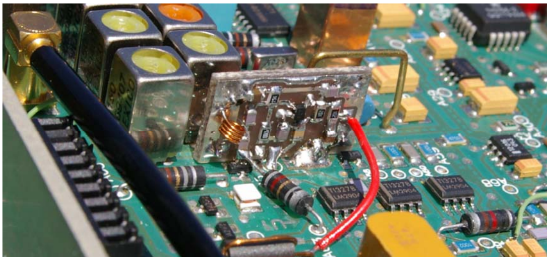
Obr. 8. ukázka instalace předzesilovače
