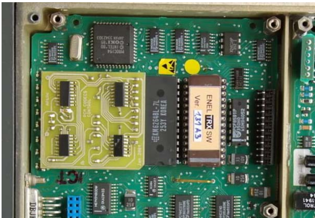
Obr. 3. Umístění obvodu PCM CODECS CONTROL a EPROM v TRX
